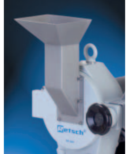
La toute nouvelle trémie du SR 300 peut être dévissée pour un nettoyage facile et rapide.
